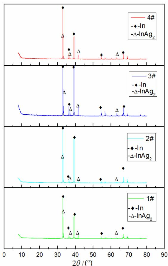
Fig.2 XRD of In-Ag Alloys 图2 钢银合金 XRD 图谱
