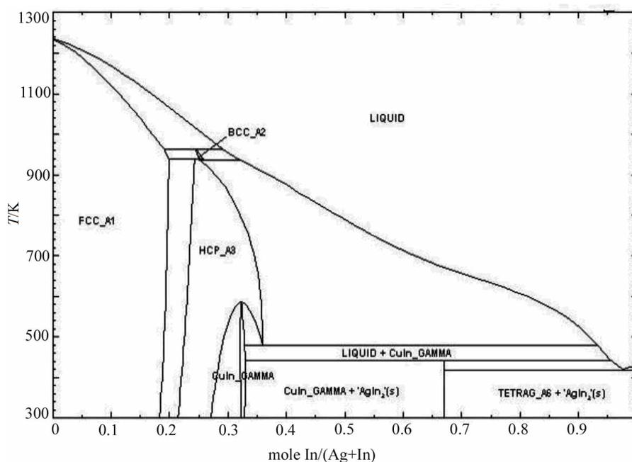
Fig.1 The phase diagram of In-Ag alloys 图 1 In-Ag 二元合金相图
