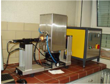
图 2 接触角测量设备 [28]
