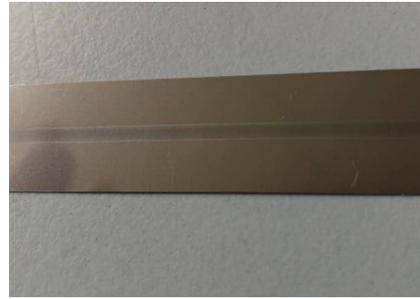
图 1 AgPdCu/CuNiSn 复合带材宏观形貌
